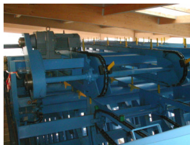
Sortierwerke mit Fall- oder Hubboxen, Filmsortierungen
